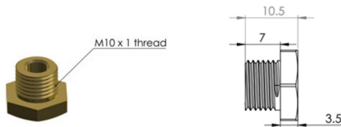
Verschlussstopfen mit Gewinde M10 x 1, Maße in mm
